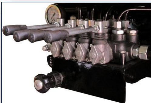
Cụm van điều khiển, ga tay và đồng hồ áp suất
