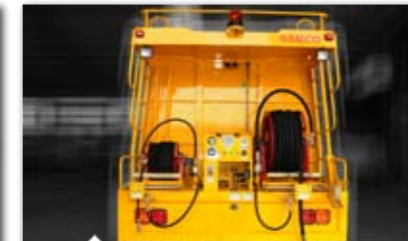
Hệ thống điều khiển và thiết bị thông cống Control system and jetting devices
