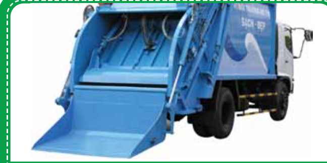
Máng ủi và nạp rác Bulldozing garbage
