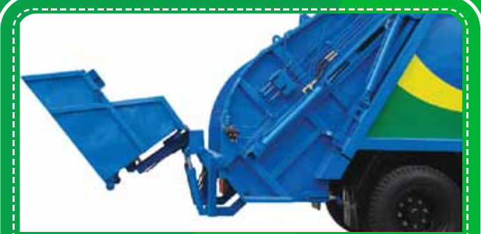
Cặp thùng rác tiêu chuẩn kết hợp với máng nạp rác có thể tháo rời Standard garbage loading structure combined with removable garbage bulldoze
