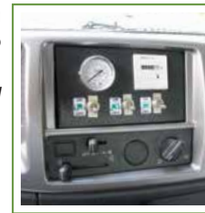
Bảng điều khiển lắp trong cabin, thuận tiện trong thao tác. Operation controlling table placed in cabin for greater convenience.
