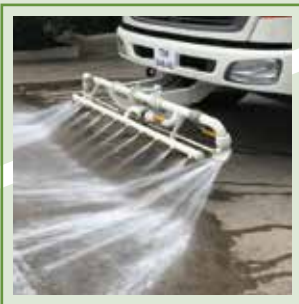
Bộ béc phun tưới rửa đường đa chức năng, có thể xếp lại khi vận hành xe thông thường. Road cleaning nozzle works multi function and foldable when unused.
