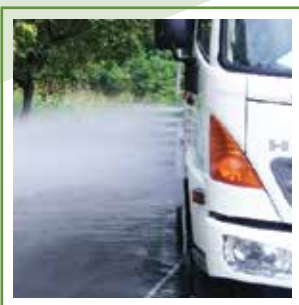
Hệ thống béc tưới bên hông nâng cao khả năng tưới cây. Side watering system upgrades truck's watering power.
