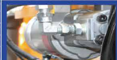
Bơm điện dùng khẩn cấp Emergency Pump
